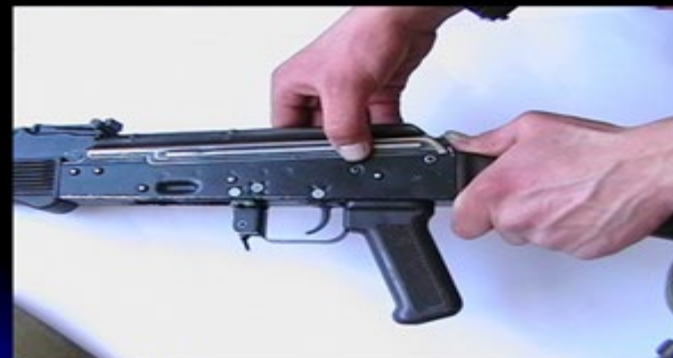
• Відокремлення кришки ствольної коробки
