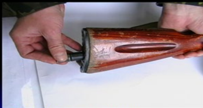
• Виймання пенала з приладдям
