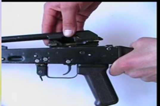
Відокремити затворну раму із затвором
