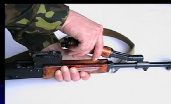
Відокремити газову трубку зі ствольною накладкою
