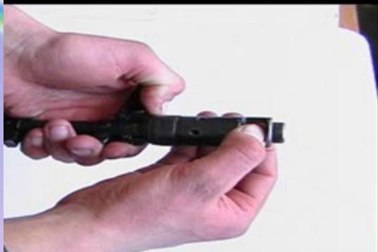
Виймання дулового гальмо-компенсатора
